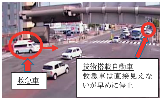
第6-12図 ITS Connect 実証実験状況（交差点）
